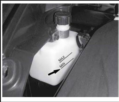
Típico - TANQUE DE EXPANSÃO DO LÍQUIDO DE ARREFECIMENTO
