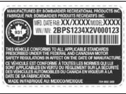
TYPISCH — HINWEISSCHILD MIT FAHRZEUGSERIENNUMMER UNTER HANDSCHUHFACH
