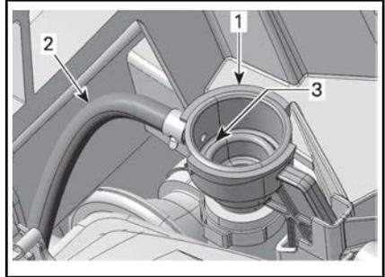
1. Adaptador de llenado del sistema de refrigeración
