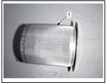
1. Limpieza del supresor de chispas
