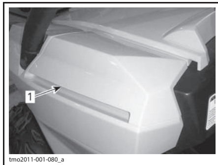
ПЕРЕДНЯЯ ЧАСТЬ МОТОВЕЗДЕХОДА — КОМПОНЕНТЫ СНЯТЫ ДЛЯ НАГЛЯДНОСТИ 1. Передняя решетка
