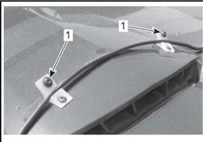
1. Tornillo de sujeción del parabrisas al soporte
