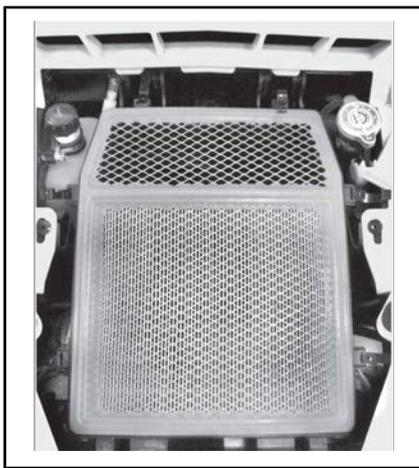
3. Compruebe que la tapa está bien colocada en el alojamiento del filtro de aire del motor antes de cerrar las sujeciones.
