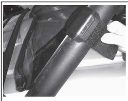
2. Entfernen Sie Befestigungsmutter, Unterlegscheibe und Schraube, die die Windschutzscheibe an der Halterung befestigen.
