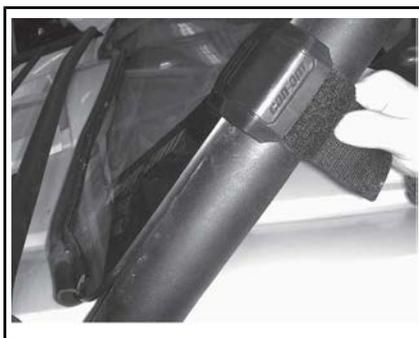
Bringen Sie die Befestigungsschrauben an der Windschutzscheibe an und ziehen Sie die Befestigungsschrauben gemäß der Vorgabe an.
