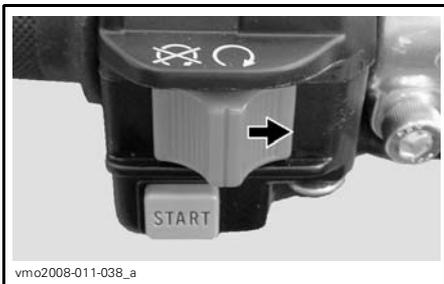
Appuyer sur le bouton de démarrage jusqu'à ce que le moteur démarre.
