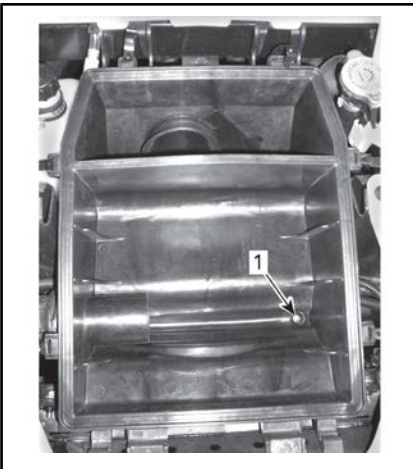
1. Orificio de drenaje
