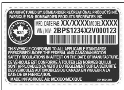
TYPISCH — HINWEISSCHILD MIT FAHRZEUGSERIENNUMMER UNTER HANDSCHUHFACH
