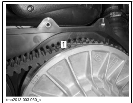
tmo2013-003-060_a 1. Bas des dents égal à la surface externe de la courroie d'entraînement
