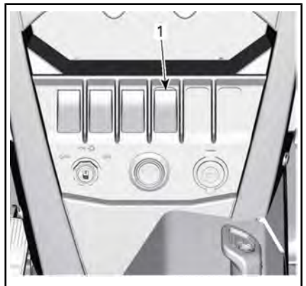
1. Interruptor de DPS
