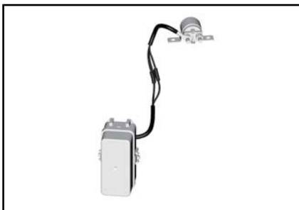
SMELTEKONTAKT KOBLET TIL SIKRINGSBOKSEN
