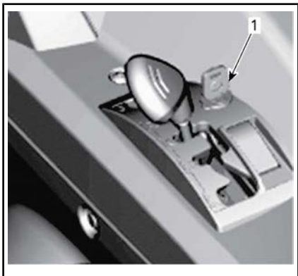
TYPISK - GIRSPAKEN KAN LÅSES I PARKERT STILLING
