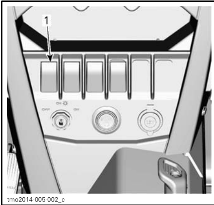
1. Interrupteur de feux de détresse
