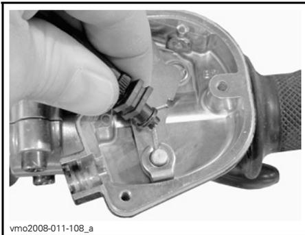
Entfernen Sie die Seitenabdeckung der Drosselklappe.
