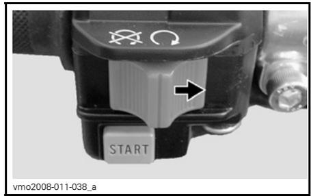
Schalten Sie auf Stellung NEUTRAL oder drücken Sie den Feststellhebel für die Kupplung.
