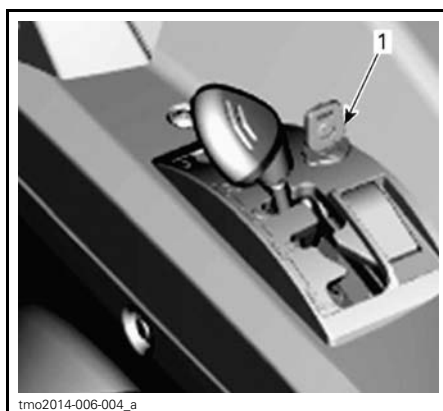
TYPIQUE - LE LEVIER SÉLECTEUR PEUT ÊTRE VERROUILLÉ À LA POSITION «P» 1. Clé de verrouillage du levier sélecteur
