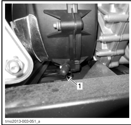
1. Drain de la transmission CVC
