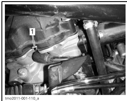
CÔTÉ DROIT — CYLINDRE ARRIÈRE 1. Bougie
