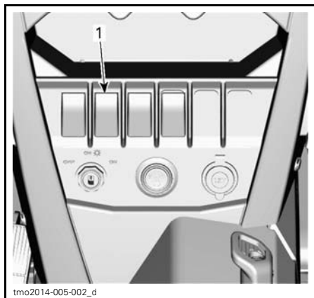
1. Sélecteur de mode 2 ou 4 roues motrices
