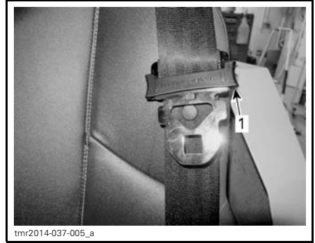
CEINTURE DE SÉCURITÉ ENGAGÉE 1. Languette de verrou coulissante
