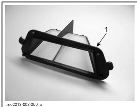
1. Filtre à air de transmission CVC
