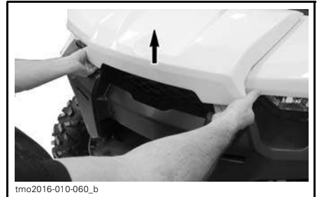
tmo2016-010-060_b SOULEVER LE REBORD DU COUVERCLE DE SERVICE AVANT
