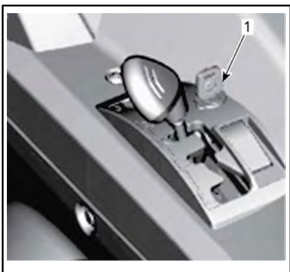
TYPISK - GIRSPAKEN KAN LÅSES I PARKERT STILLING
