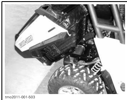
tmo2011-001-503 LA PARTIE AVANT DE LA CARROSSERIE CARGO INCLINÉE DOIT ÊTRE LIBRE
