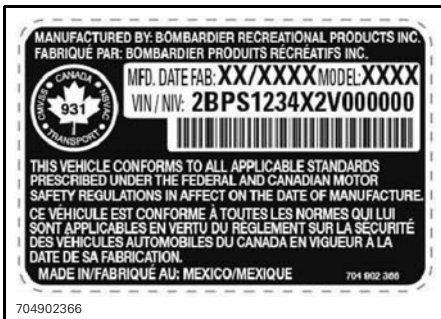
TYPIQUE — ÉTIQUETTE DU NUMÉRO DE SÉRIE DU VÉHICULE SOUS LA BOÎTE À GANTS
