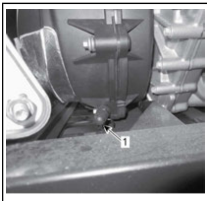
1. Drenagem da CVT
