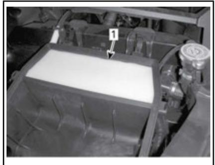
1. Post-filtro dell'aria del motore
