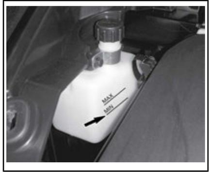
**SERBATOIO DI ESPANSIONE DEL LIQUIDO REFRIGERANTE**
