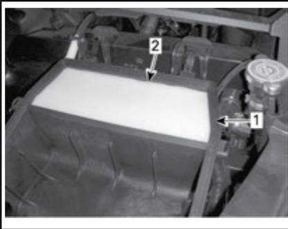
1. Seconda sezione (camera pulita)
