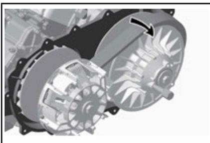
**Installazione della cinghia di trasmissione**
