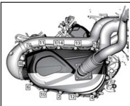
**SEQUENZA DI SERRAGGIO DELLA CARENATURA DELLA CVT**
