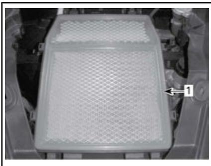
1. Filtro dell'aria del motore
