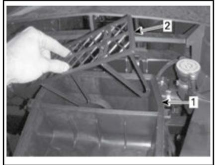
1. Seconda sezione (camera pulita)
