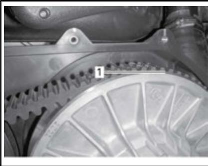
1. Porzione più bassa delle ruote dentate sulla superficie esterna della cinghia di trasmissione in linea con l'estremità della puleggia
