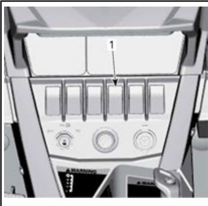
1. Interruptor de DPS
