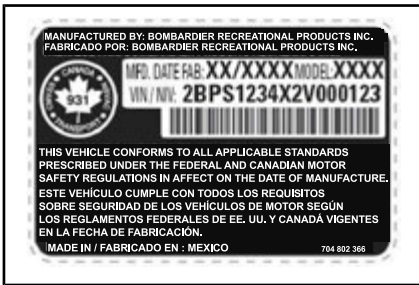
TÍPICO — ETIQUETA CON EL NÚMERO DE SERIE DEL VEHÍCULO BAJO LA GUANTERA
