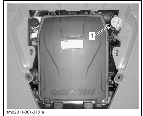
1. Bouchon à pression du radiateur
