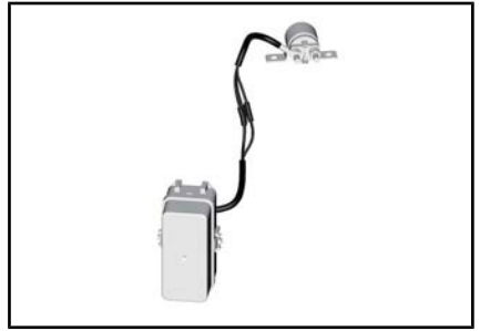
SÄKRINGSLEDNING ANSLUTEN TILL SÄKRINGSBOX
