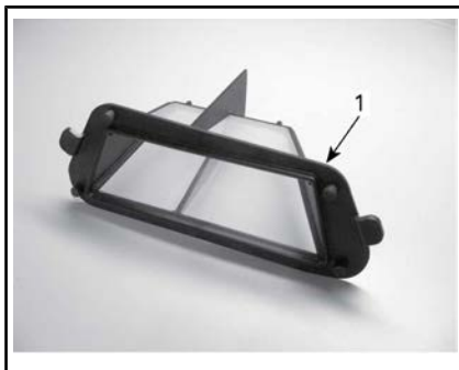
1. Filtro de aire de la CVT
