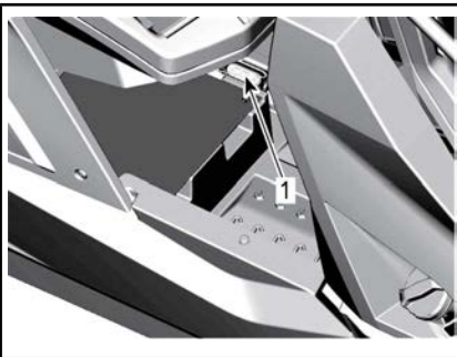
1. Caixa de fusíveis auxiliar
