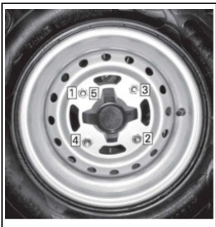
REIHENFOLGE BEIM ANZIEHEN
