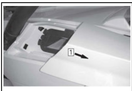
Schritt 1: Nach hinten schieben
