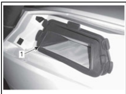
1. Filtro de aire de la CVT
