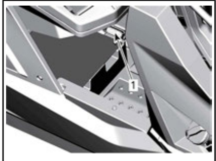
1. Caja de fusibles auxiliar
