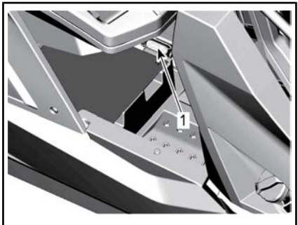
1. Caja de fusibles auxiliar
