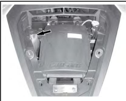
El refrigerante debería llegar hasta la marca **MIN** con el motor FRÍO.
