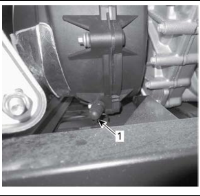
1. Drenaje de la CVT
