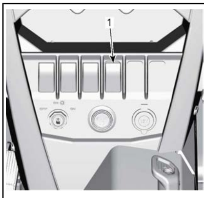
1. Interruptor de DPS
