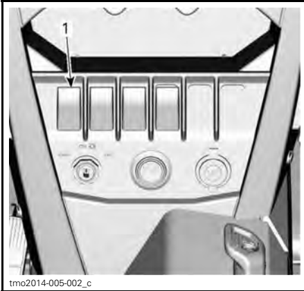
1. Interrupteur de feux de détresse
