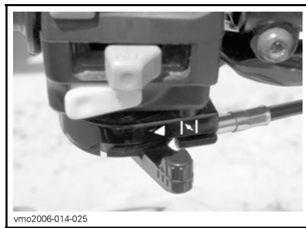
ALAVANCA DO ESTRANGULADOR NA POSICÃO OFF
