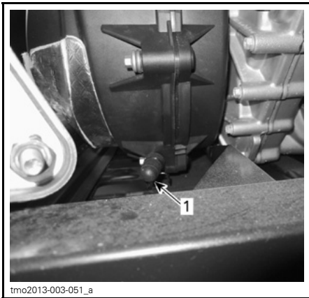
1. CVT:n (portaaton voimansiirto) tyhjennysnipa
