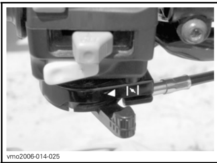
TYPEBILDE – CHOKESPAK I POSISJONEN OFF (AV)
