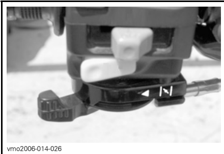
TYPEBILDE – CHOKESPAK I POSISJONEN FOR FULL CHOKE
