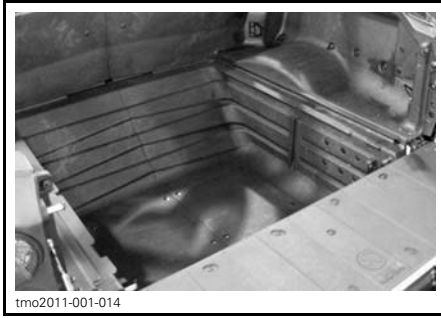
ESPACE DE CHARGEMENT SANS LE PLATEAU DE SÉPARATION
