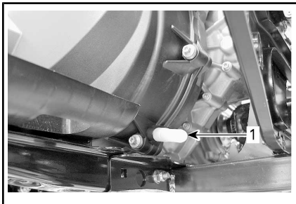
1. Drenaje de la CVT
