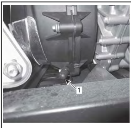
1. Drenagem da CVT
