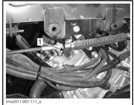
CÔTÉ GAUCHE — CYLINDRE AVANT 1. Bougie
