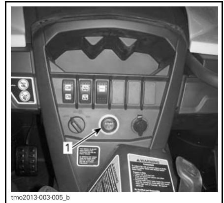
1. Bouton de démarrage du moteur
