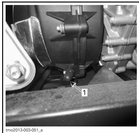
1. Drain de la transmission CVC
