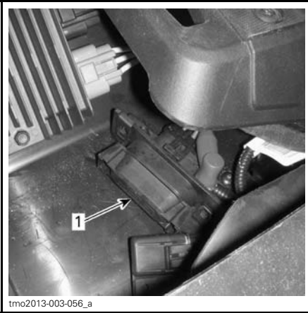
1. Boîte à fusibles auxiliaire
