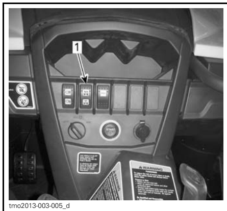
1. Sélecteur de mode 2 ou 4 roues motrices
