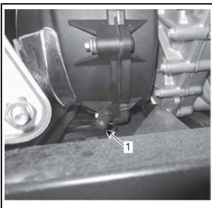
1. Drenaje de la CVT
