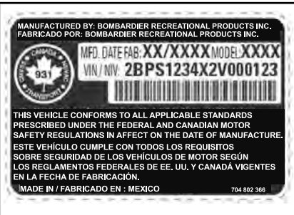
TÍPICO: ETIQUETA CON EL NÚMERO DE SERIE DEL VEHÍCULO BAJO LA GUANTE-RA
