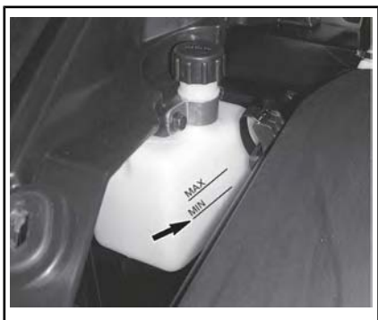
SERBATOIO DI ESPANSIONE DEL LIQUIDO REFRIGERANTE
