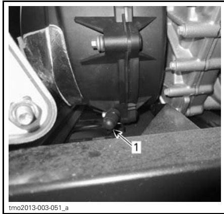
1. Drain de la transmission CVC
