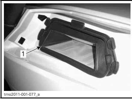
1. Filtre à air de transmission CVC
