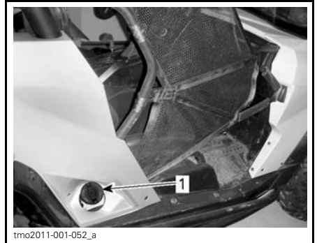
1. Bouchon du réservoir d'essence
