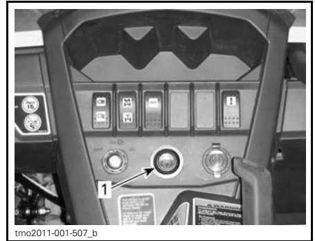
1. Bouton de démarrage du moteur
