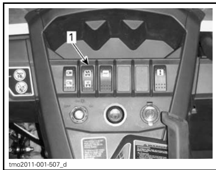
1. Sélecteur de mode 2 ou 4 roues motrices
