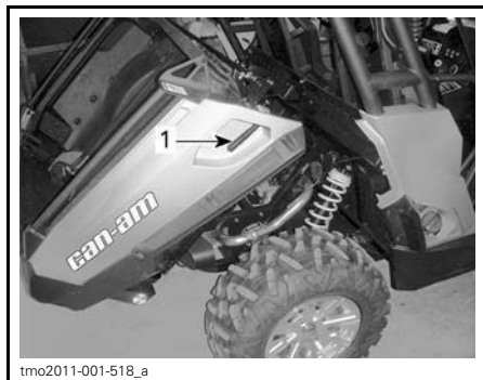
1. Poignée de déclenchement droite
