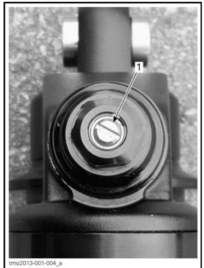
典型图示 - LTD 型号 1. 低速压缩调节器
