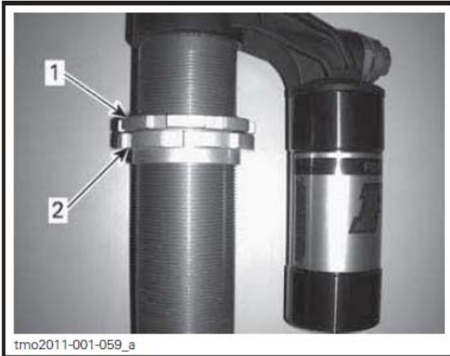
典型图示 - 弹簧未显示 1. 松开上面锁环 2. 相应地转动调节环
