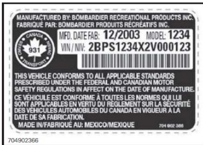
典型图示 – 车身序号 标签在手套箱下面
