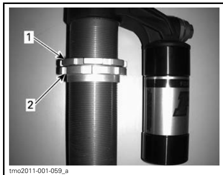
TYPIQUE - RESSORT NON ILLUSTRÉ 1. Desserrer l'anneau de verrouillage supérieur 2. Tourner l'anneau de réglage en conséquence
