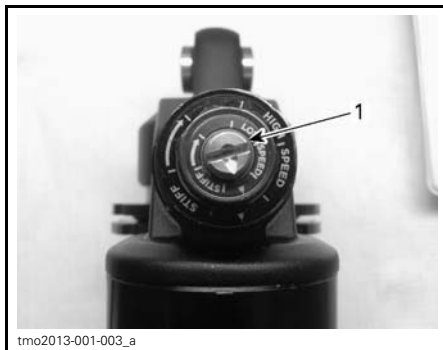
TYPIQUE - MODÈLE X 1. Régleur de compression pour basse vitesse
