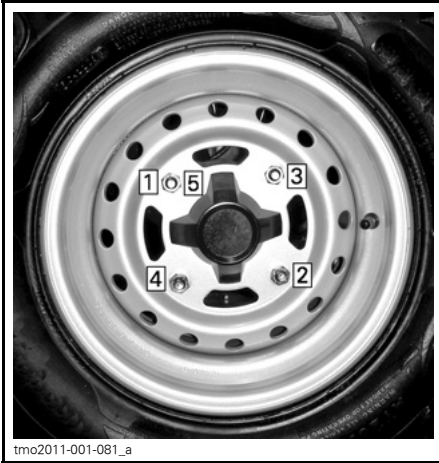
REIHENFOLGE BEIM ANZIEHEN
