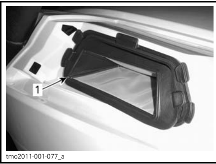
1. Filter à air de transmission CVC
