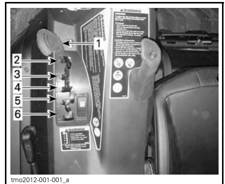
1. Schalthebel 2. Park-Position 3. Rückwärts 4. Neutral 5. Bereich für hohe Geschwindigkeit (vorwärts) 6. Bereich für niedrige Geschwindigkeit (vorwärts)
