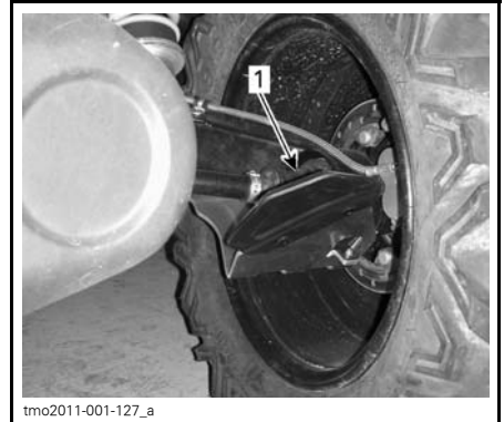
PARTE TRASERA DEL VEHÍCULO 1. Fuelle del eje motriz exterior
